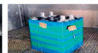
Prova di riscaldamento
